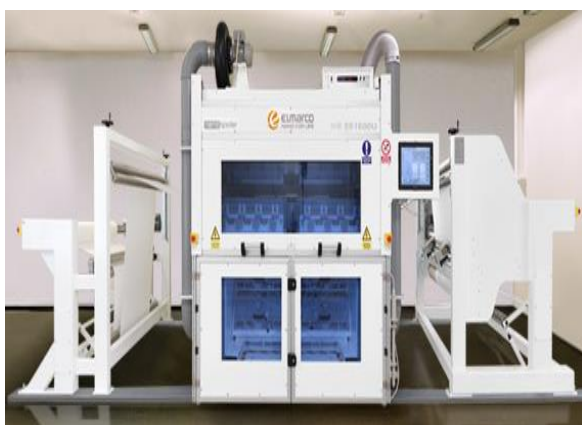
Рис. 7. Промышленная установка для электроформования Elmarco [27]
