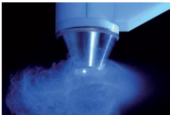
Рис. 9. Прядильная установка для центробежного спиннинга [29]
