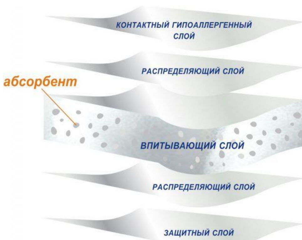
Рис. 56. Составляющие элементы подгузника [95]
